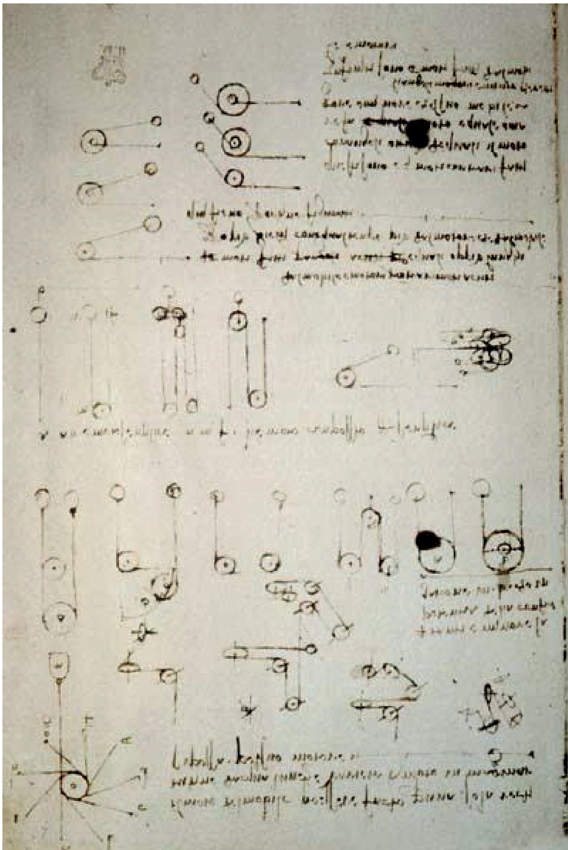
Figura 2. Diseño del Caballero Robot encontrado en Codex Atlanticus de Leonardo da Vinci.
